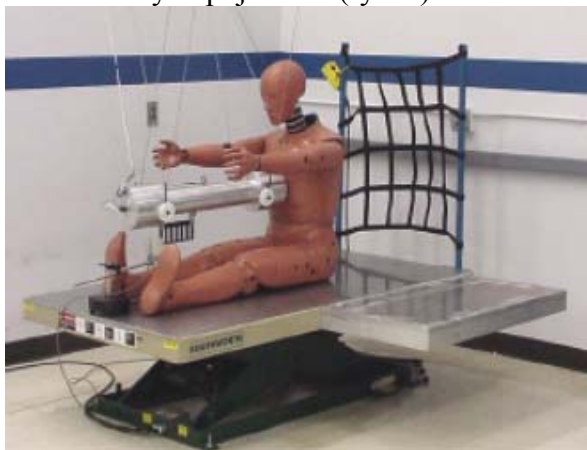
Rys. 4. Pozycjonowanie manekina do badań biozgodności modułu klatki piersiowej Fig. 4. Thorax module positioning for calibration procedure.
