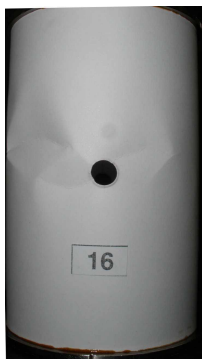
Рис. 2. – Локальная форма потери устойчивости оболочки с отверстием d = 8 мм
