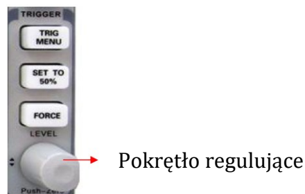
Rys. 3. Pokrętło do regulacji poziomu wyzwalania w układzie wyzwalania podstawy czasu.
