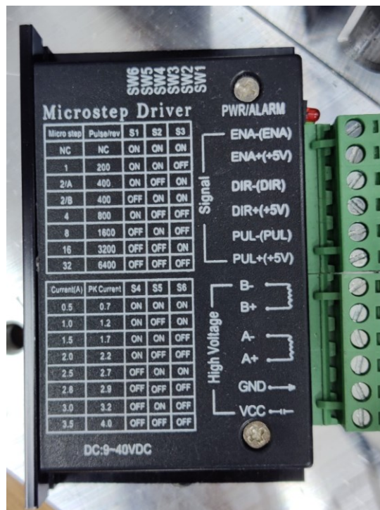
rys. 11 Zdjęcie sterownika silnika krokowego TB6600
