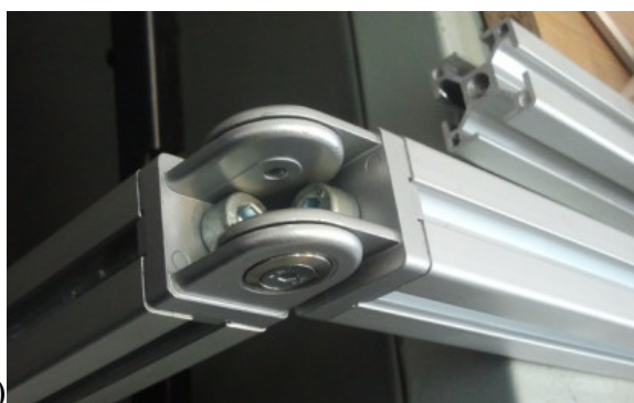
Rysunek 5. Elementy badanej konstrukcji płaskiej (a) połączone przegubem (b).
